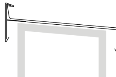
Szkic 11: Obróbka dwuelementowa z odgięciem
